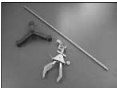
1. 理化学実験用器具のスタンドと両開きクランプを用意します。
